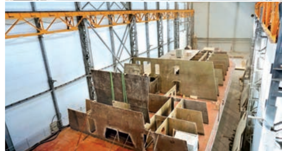
▲ Сборка стеклопластиковой надстройки для корвета пр. 20380
