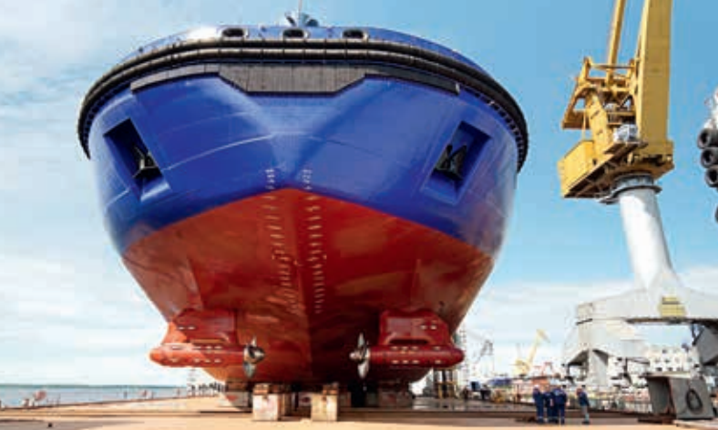
Винто-рулевая колонка Aziprod на портовом ледоколе «Обь» проекта Aker Arc 124
