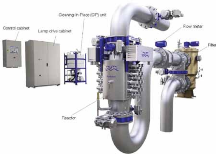
Рисунок 15. Внешний вид оборудования СОБВ, устанавливаемый на сухогрузном судне проекта RSD49
