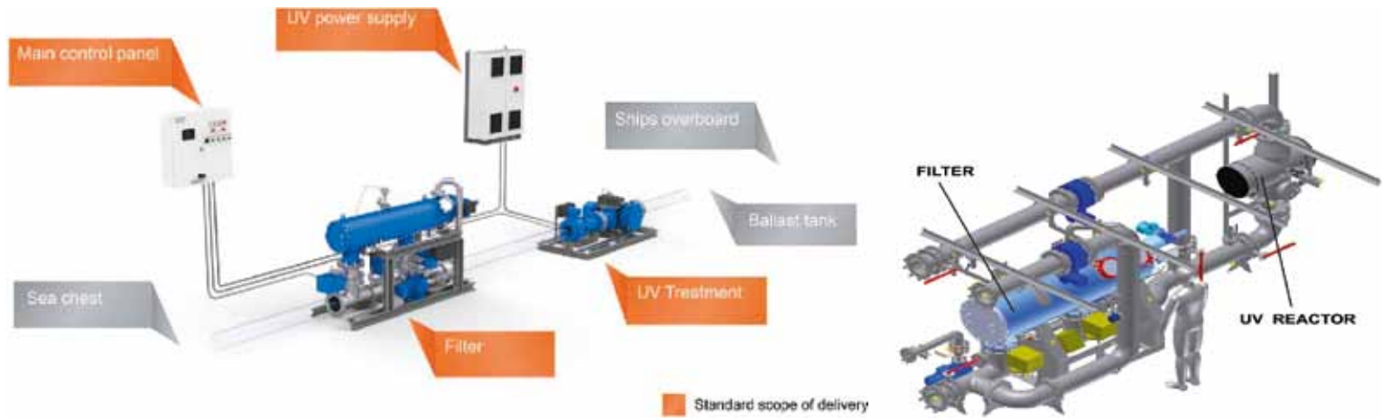
Рисунок 5. Внешний вид оборудования СОБВ, устанавливаемый на танкере-химовозе проекта RST27
